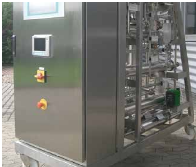
Mobile water treatment on a rolling rack (source: Letzner Pharmawasseraufbereitung GmbH, Hückeswagen, Germany).
